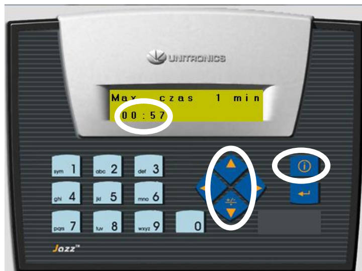
Rysunek 9. Wyświetlanie ustawień maksymalnego czasu pracy, oraz czas pozostały do zamiany pomp.
