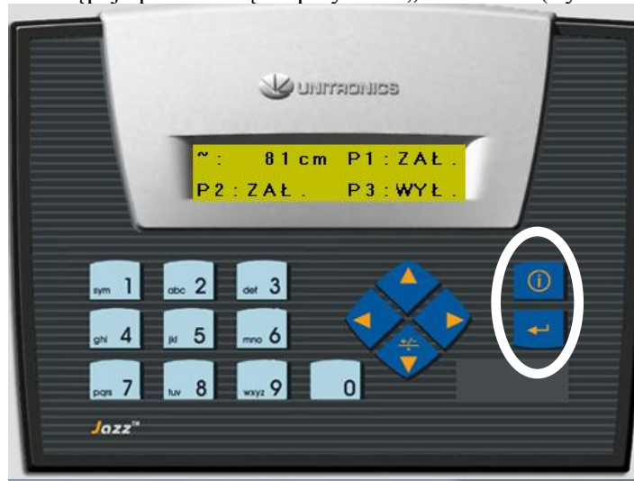
Rysunek 2. Widok pulpitu z oznaczonymi przyciskami „enter” oraz „wstecz”.
