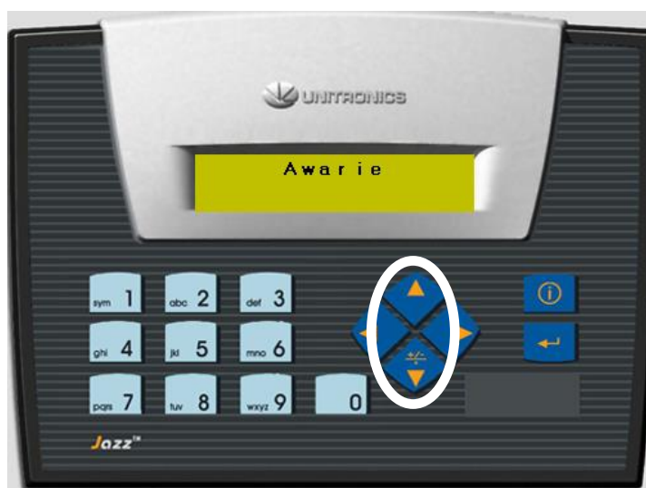
Rysunek 3. Przyciski „górę” i „w dół” na panelu operatorskim
