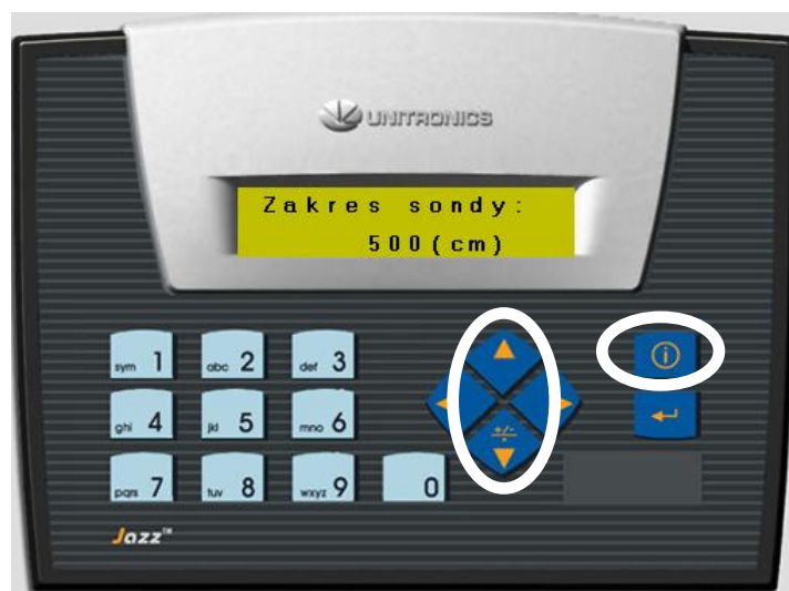
Rysunek 8. Wyświetlanie ustawionego zakresu sondy.
