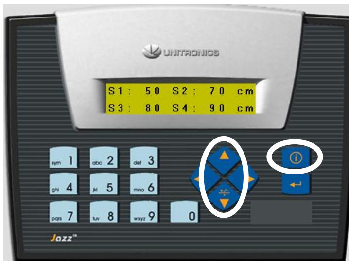
Rysunek 7. Wyświetlanie aktualnych ustawień poziomów.
